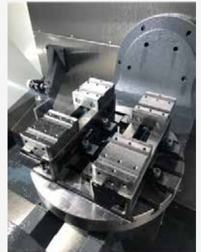
テーブルの回転範囲にピッタリ収まるよう選定したバイス
